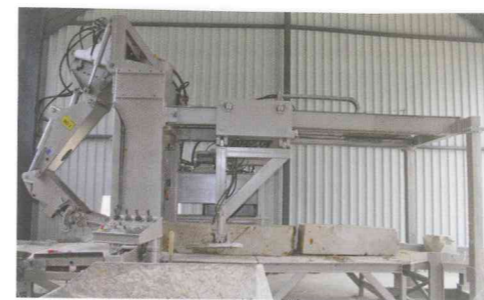
Bild 2: Gestra Spaltanlage mit 3 000 kN (300 t) Spaltkraft und Manipulator-technik
