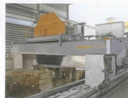
Bild 2: Gestra Spaltanlage mit 3 000 kN (300 t) Spaltkraft und Manipulator-technik
